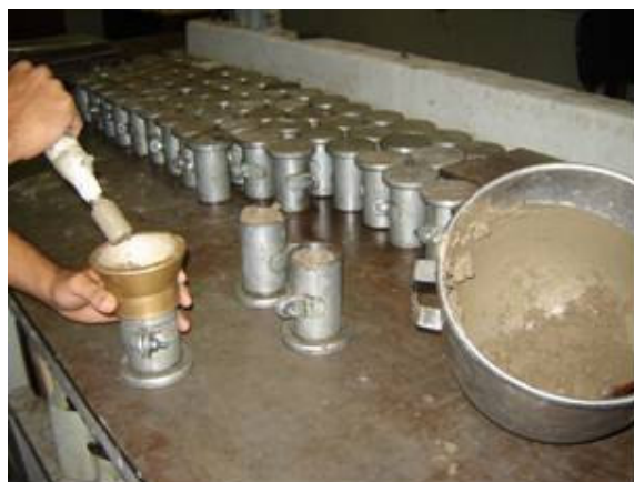
Figura 3: Moldagem dos Corpos-de-prova
